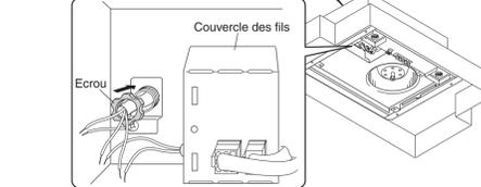
3 Connectez les fils électriques de la manière suivante: Serrez les fils bien fermement en utilisant des connecteurs de fils (non fournis).
