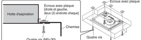
3 Serrez le joint de conduite et rendez-le étanche à l'air avec du ruban ignifuge comme du ruban en aluminium, etc. (non fourni).
