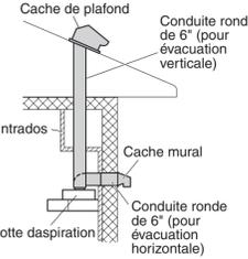
2 La hotte d'aspiration doit être montée sur une chemise ayant les dimensions suivantes. Installez la chemise solidement après avoir vérifié que la taille de l'ouverture de la chemise est la même que sur la figure ci-dessous.
