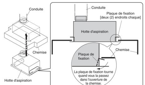
2 Amenez les 4 orifices de vis de la chemise en regard de ceux de la hotte d'aspiration, puis fixez solidement à l'aide des vis et des écrous fournis.
