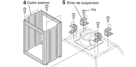
6 Tout en insérant le cadre intérieur dans le cadre extérieur et le port d'échappement dans le conduit, soulevez la hotte d'aspiration et faites passer les tiges filetées dans les étriers de suspension comme indiqué.
