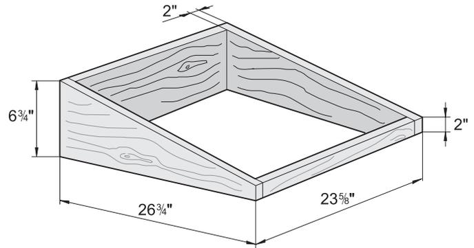
Pour le montage sur un toit plat ou sur un toit ayant une pente inférieure à 10°, montez l'appareil sur un cadre comme indiqué. Placez le cadre sur le toit plat de façon à ce que l'extrémité de la décharge soit orientée dans le sens opposé aux vents dominants.
